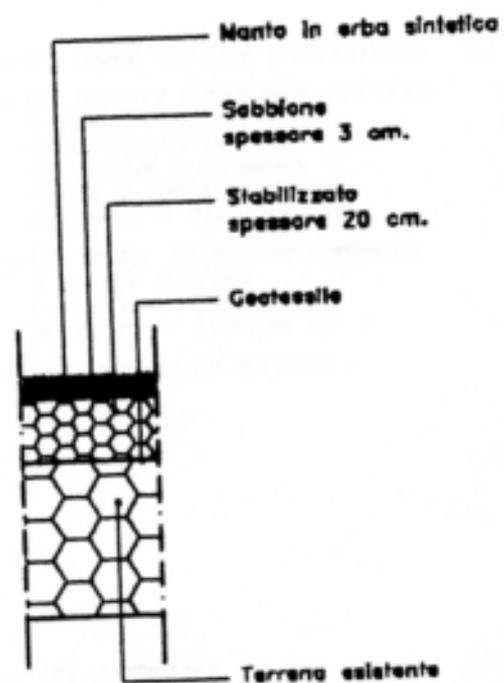
SEZIONE TIPO SOTTOFONDO
